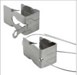
Die Grat-/Kehlklammer ist zur Befestigung von geschnittenen Dachpfannen im Bereich der Kehle und des Grats sowie ggf. um den Bereich eines Fensters, Kamins konzipiert worden. Mit den Klöber Grat- und Kehlklammern wird die mechanische Befestigung dauerhaft und witterungsbeständig gewährleistet. Sie ermöglicht eine Reduzierung der Verlegezeit und vermeidet den Pfannenbruch beim Bohren. Die Grat-/Kehlklammer ist universell für eine Vielzahl von Profilen verwendbar.
